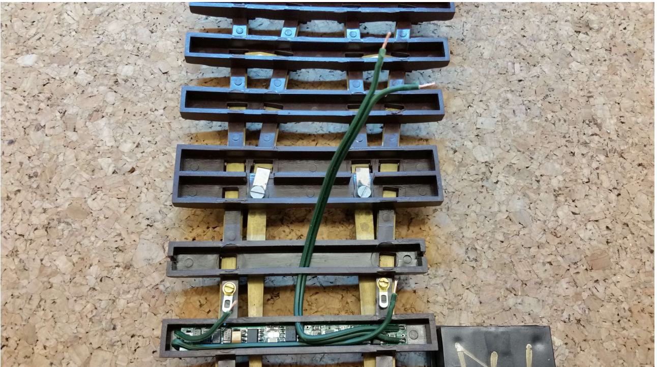
Abbildung 15: Abisolieren und Verzinnen
